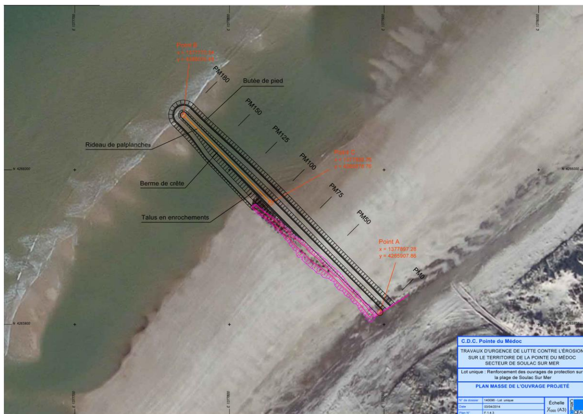
Fig. 85. Vue en plan de l'extension de l'épi Barriquand (dossier de consultation des entreprises, 2014)
