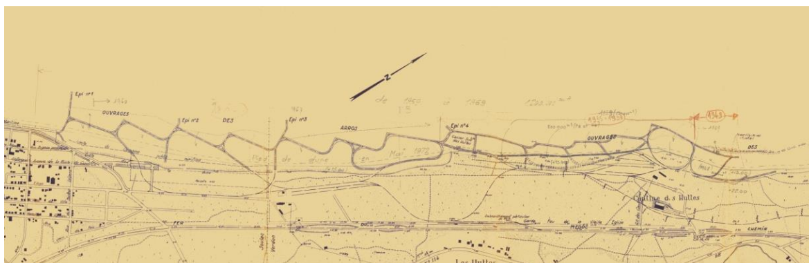
Fig. 53. Etat des aménagements sur le littoral des Arros aux Huttes en 1950 (données GPMB)
