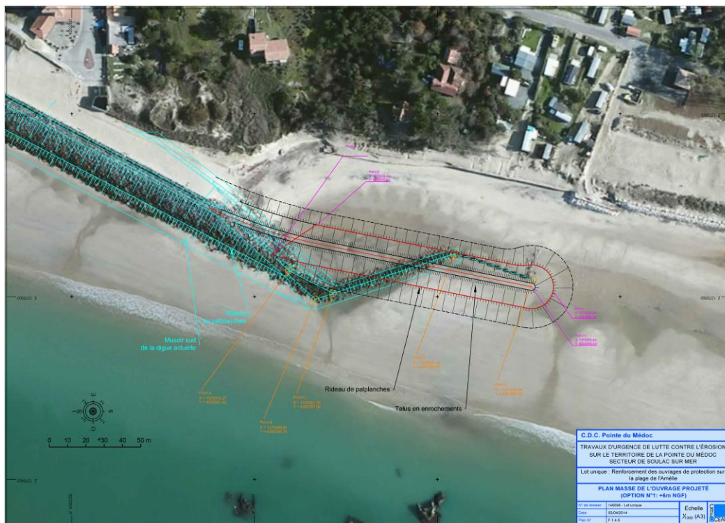
Fig. 83. Vue en plan de l'extension vers le sud de la protection de l'Amélie-Plage (dossier de consultation des entreprises, 2014)
