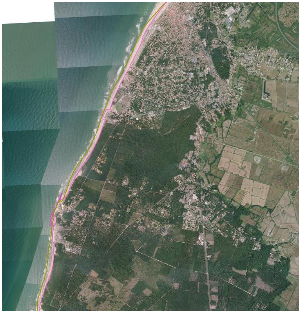
Evolution du trait de côte entre 2000 et 2016 (trait marron et trait rose) Exemple sur la commune de Soulac-sur-Mer Observatoire Régional des Risques, Cartographie informative.
