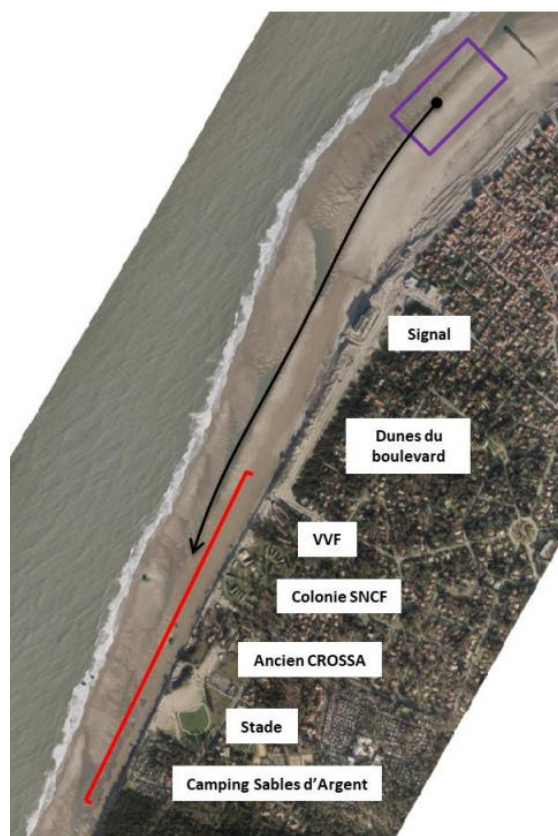
Schéma illustrant le mécanisme de rechargement des plages du sud grâce aux sables prélevés sur la plage centrale 6
